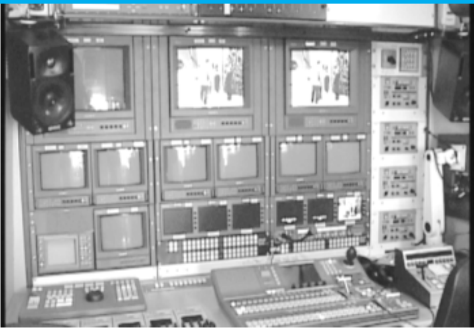
Carul de reportaj este dotat cu 6 camere de luat vederi și pupitrele necesare pentru înregistrarea și transmiterea imaginii și a sunetului
