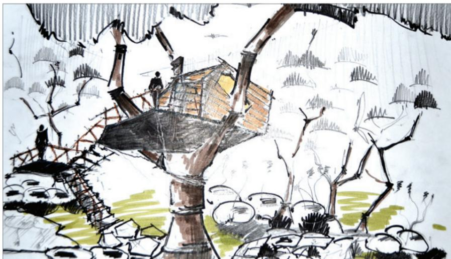
Având ca funcțiune, loc de relaxare și odihnă pentru câteva zile, această casă din copac se află în zona Deltei Dunării. Construcția este realizată din materiale locale: lemn și trestie pentru acoperire și are în componență un loc de dormit, unul pentru prepararea hranei și un grup sanitar.
